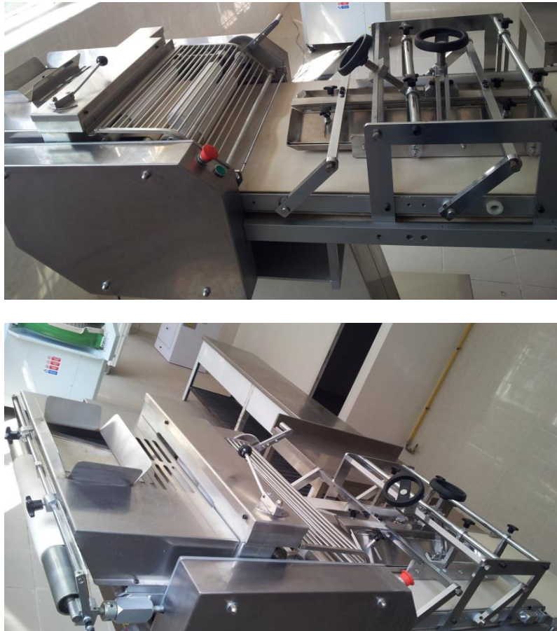
Fig. 2. Elemente de reglare la mașina de modelat lung RO-CR-600
